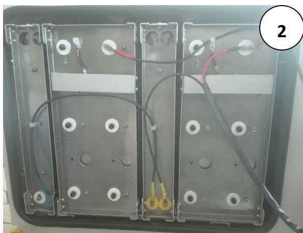
Odczep przewody części jonizatora oraz kolektora. W zależności od wersji zamontowane są 1 lub 2 moduły.
